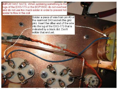
Figure 28. Wiring  $L_2$  (part 1).
