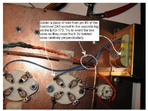
Figure 29. Wiring  $L_2$  (part 2).
