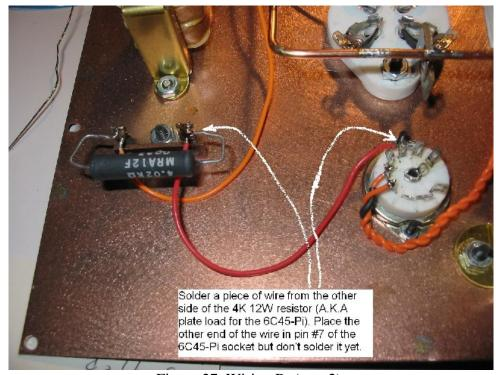
Figure 27. Wiring R<sub>3</sub> (part 2).
